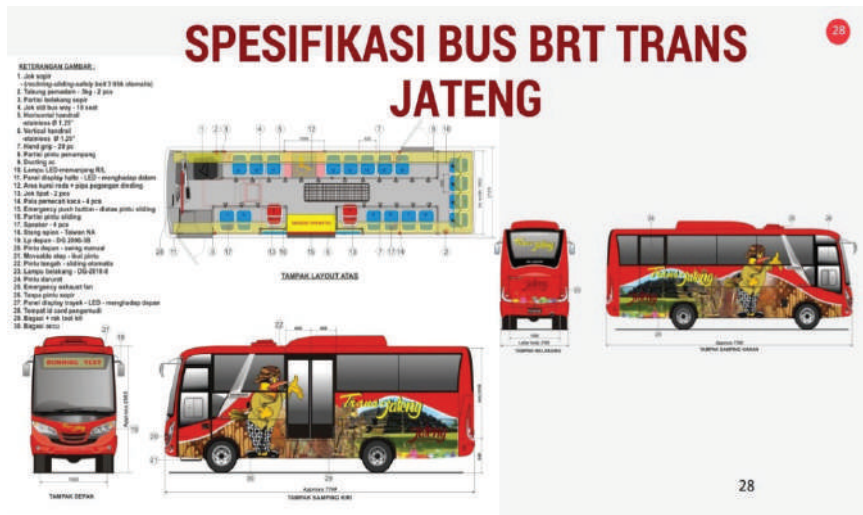
Gambar 3 Spesifikasi Bus BRT Trans Jateng
